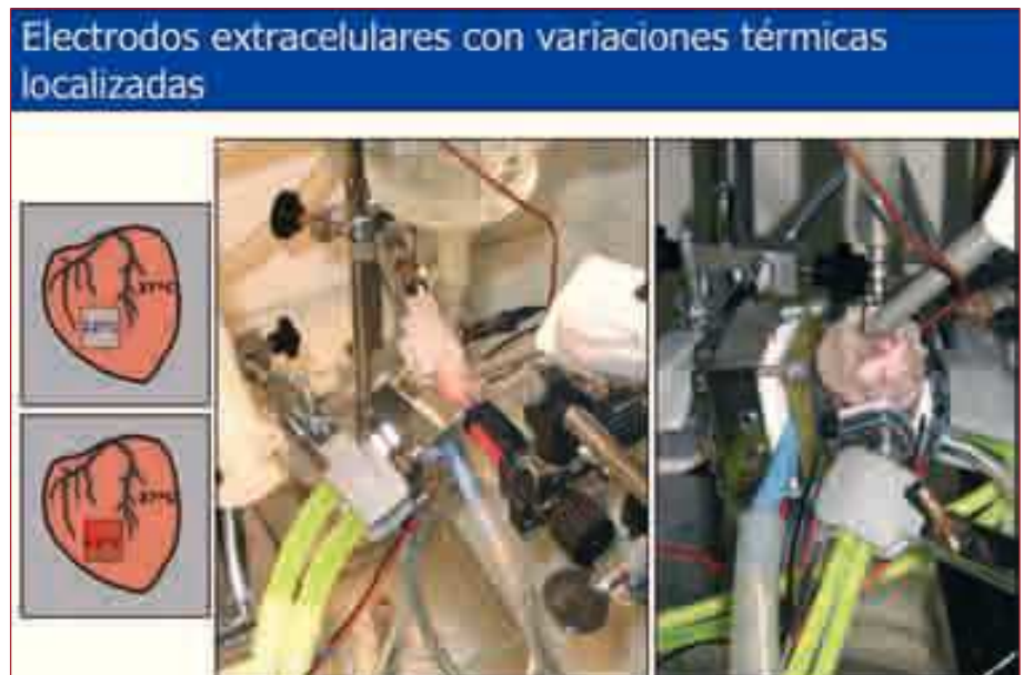
Fig. 6. Dispositivos utilizados para efectuar estudios cartográficos de la actividad eléctrica cardíaca introduciendo variaciones térmicas localizadas en el corazón aislado y perfundido de conejo.
