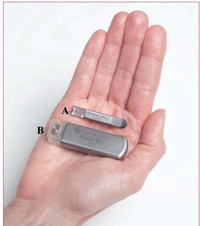
Figura 1. El monitor cardiaco insertable Reveal LINQ de Medtronic (A) ofrece monitorización del ritmo cardiaco, incluida la detección de fibrilación auricular, durante aproximadamente 3 años; presenta una reducción muy significativa de tamaño y una mejora del algoritmo de detección de fibrilación auricular 19 con respecto a su predecesor, el Reveal XT (B).
